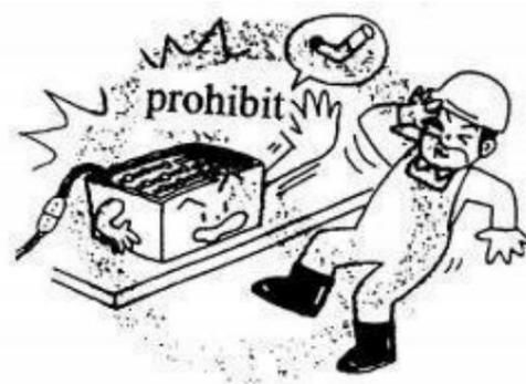
**Proteção contra choque elétrico:** • A bateria tem alta voltagem e energia. • Não provoque curto-circuito. • Não aproxime ferramentas dos dois polos da bateria, o que pode causar faíscas.
